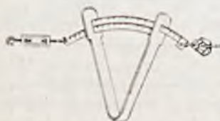
RYŚ. 4. SIŁOMIERZ W POSTACI ZGIĘTEGO PASKA STALOWEGO.
