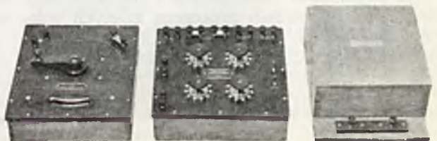
RYŚ. 24. ZESPÓŁ DO POMIARU KRZYWICH OPORNOŚCI POZORNICH, W ZALEŻNOŚCI OD CZĘSTOTLIWOŚCI W WYKONANIU F. „STANDARD”.
