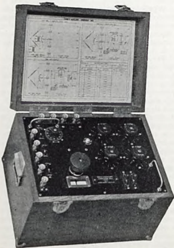
RYŚ. 10. PRZYRZĄD DODATKOWY DO POMIARU POJEMNOŚCI WZAJEMNEJ W WYKONANIU F. „STANDARD”.
