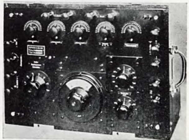
RYC. 4. PRZYRZĄD DO POMIARU NIERÓWNOGAWY POJEMNOŚCIOWEJ W WYKONANIU F. „SIEMENS”.
