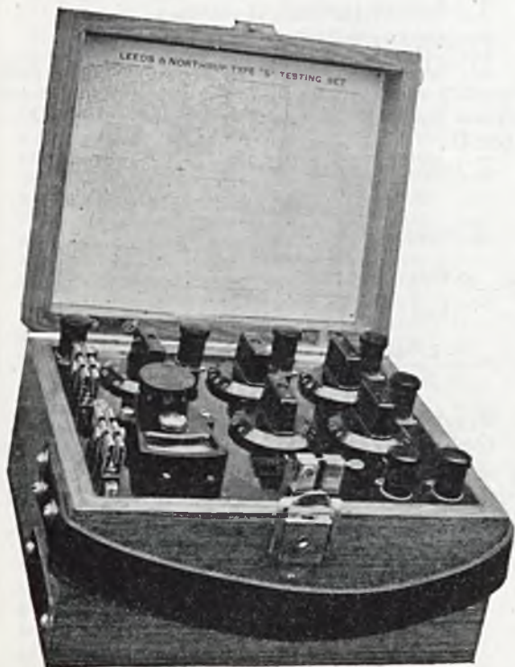
RYC. 11. PRZENOŚNY PRZYRZĄD DO POMIARU OPORNOŚCI OMOWEJ W WYKONANIU F. „STANDARD“.
