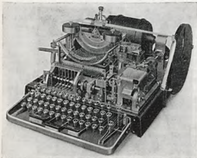
RYŚ. 3. DALEKOPIS ZE ZDJĘTĄ PRZYKRYWĄ OSŁONNĄ.
