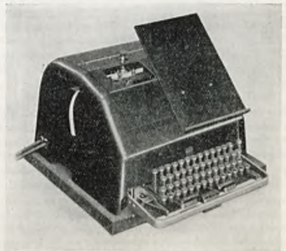
RYC. 2. DALEKOPIS DRUKUJĄCY NA TAŚMIE TELEGRAFICZNEJ.
