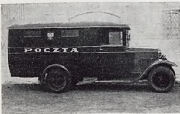
RYŚ. 4. SAMOCHÓD CIĘŻAROWY „URUSUS TYP A” SERJA 1930 R. O NADWOZIU FURGONOWYM; TYP USTALONY PRZEZ M. P. I T. O MOCY SILNIKA 45 K. M. (4 CYLINDRÓW) O NOŚNOŚCI UŻYTECZNEJ 2 1/2 TONNY I POJEMNOŚCI ŁADUNKOWEJ 7 M 3 .
