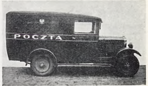
RYŚ. 5. SAMOCHÓD CIĘŻAROWY „POLSKI FIAT” — MOD. 614 MOCY SILNIKA 16. K. M. (4 CYL.) O NOŚNOŚCI 1 TONNY (NADWOZIE FURGONOWE).
