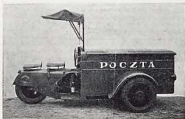
RYS. 3. TRÓJKOŁOWIEC CIĘŻAROWY „TATRA — TYP 49” O MOCY SILNIKA 8. K. M. (1 CYL.) I UŻYTECZNEJ NOŚNOŚCI 500 KG.
