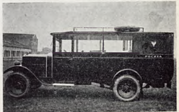
RYŚ. 6. AUTOBUS POCZTOWY NA PODWOZIU „URUSUS TYP A” SERJA 1928 R. O MOCY SILNIKA 45 K. M. (4 CYLINDRY) I NOŚNOŚCI UŻYTECZNEJ 2 1/2 TONNY, NA 9-CIU PASAŻERÓW+2 LUDZI DO OBSŁUGI.
