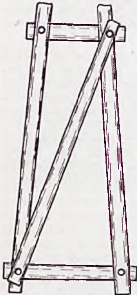
RYŚ. 5. UMCOWANIE SŁUPA A-OWEGO BELKĄ PRZEKĄTNĄ.
