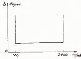
RYS. 2. WYKRES SKUTECZNEGO TŁUMIENIE UKŁADU IDEALNEGO.
