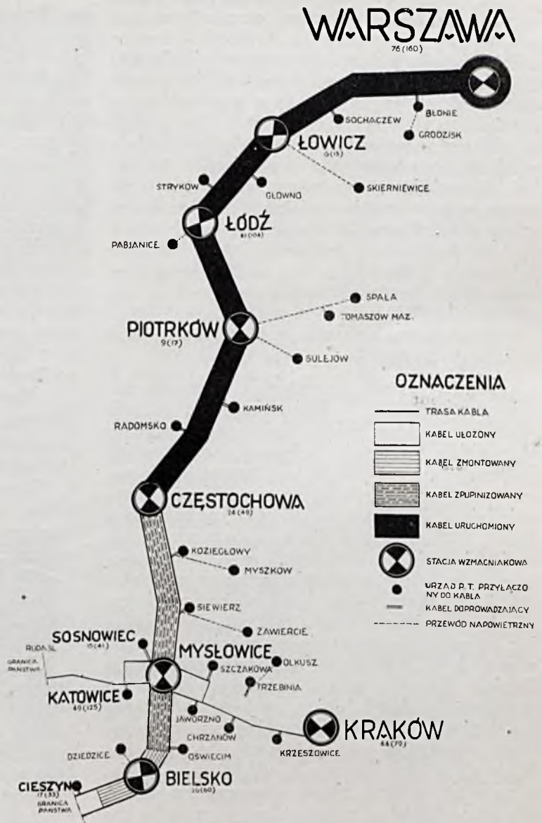
RYS. 2. STAN ROBÓT PRZY BUDOWIE KABLA DALEKOSIĘŻNEGO W LISTOPADZIE 1931 R.
