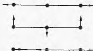
Rys. III.4-4. Oscylacje liniowej cząsteczki trójatomowej
