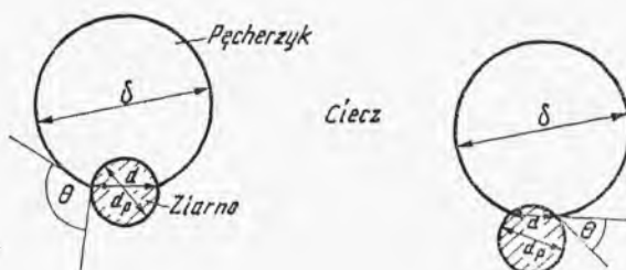
Rys. I.6-9. Zasada flotacji mineralnej
