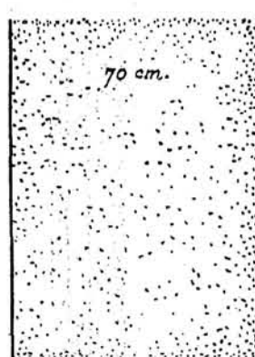
8. Ściana piaskowo-wapienna z mieszanki: 1 cz. ciasta wap.; 6 cz. piasku (może być z dodatkiem 10% cementu — w stosunku do ciasta wap.)
