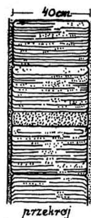
16. Ściana ze słomy moczonej w glinie i układanej w postaci regularnych wiązanek.
