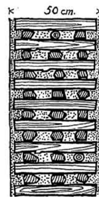
10. Ściana z drzewa opałowego, kładzonego na zaprawie wapiennej.
