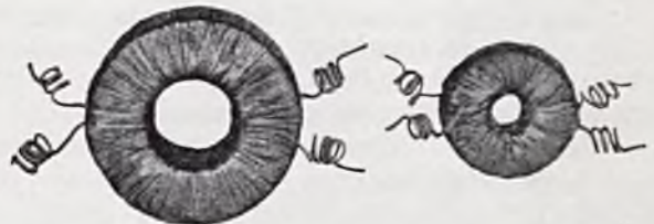
RYS. 12. CEWKI Z PROSZKU PERMALLOY'OWEGO I ŻELAZNEGO.
