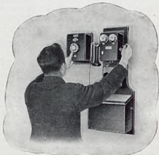
RYS. 7. ZASTOSOWANIE DODATKOWEJ SKRZYŃKI WYBIERCZEJ DO ZWYKŁEGO APARATU TELEFONICZNEGO.
