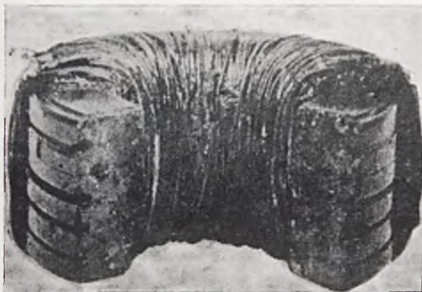
RYŚ. 1. CEWKA PUPINA NA RDZENIU PIERŚCIENIOWYM ZŁOŻONYM Z PIERŚCIEŃ, PRASOWANYCH Z PROSZKU ŻELAZNEGO. CZĘŚĆ PIERŚCIEŃ ZOSTAŁA WYŁAMANA DLA ZILUSTROW. BUDOWY RDZENIA.
