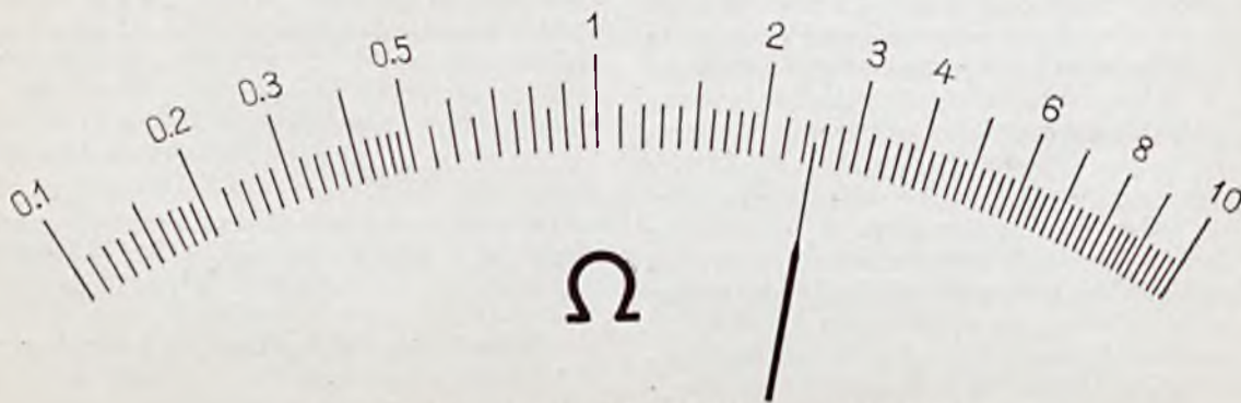
RYC. 3. WZÓR SKALI OMOMIERZA KRZYŻOWEGO.
