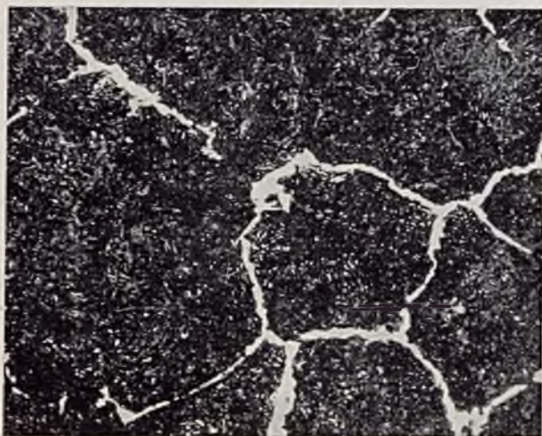
RYŚ. 6a. STAL POWYŻEJ 0,9% C o HART. I LEKKO ODPUSZCZONA, POW. 500 × Ø.
