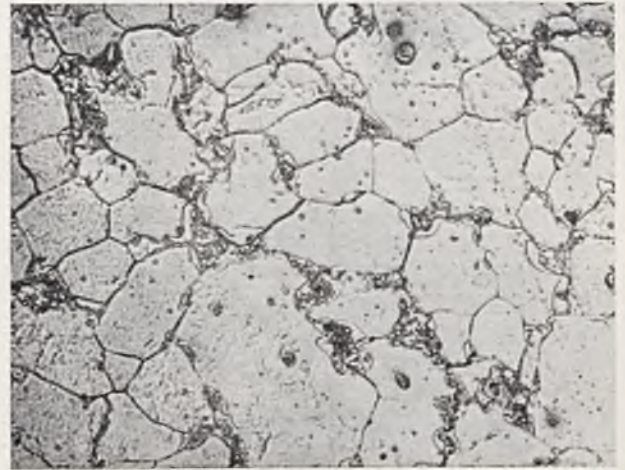
RYS. 8b. STAL WĘGLISTA O OKOŁO 0,2% C POW. 500 × Ø.
