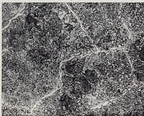
RYŚ. 6b. STAL, JAK NA RYŚ. 6a, PO WYŻARZENIU, POW. 500 × Ø.
