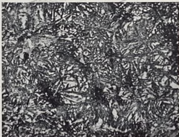
RYS. 5a. STAL STOPOWA HARTOWANA I LEKKO ODPUSZCZONA, POW. 500 × Ø.
