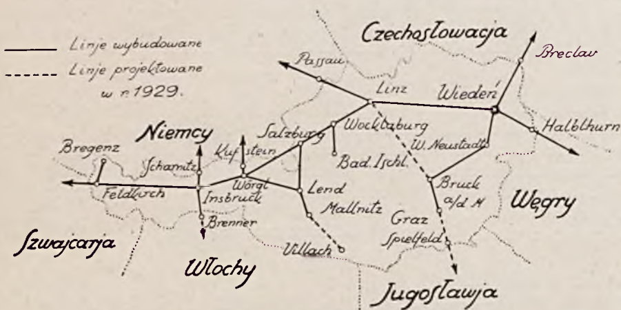
RYŚ. 1. SCHEMAT ROZBUDOWY SIĘCI KABLOWEJ W AUSTRII.
