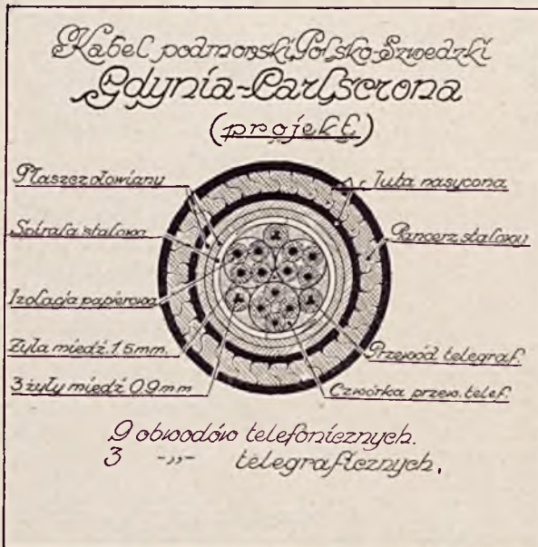
RYŚ. 2. PRZEKRÓJ PROJEKTOWANEGO KABLA PODMORSKIEGO POLSKA-SZWECJA.
