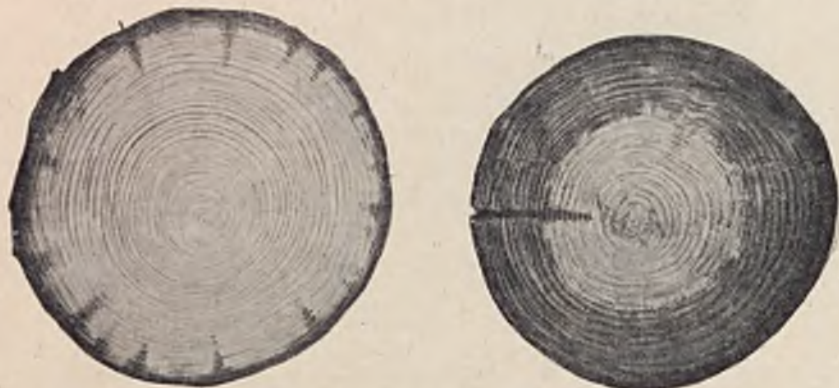
RYS. 1. PRZESIĄKANIE IMPREGNATEM PNIA DRZEWNEGO. A) PRZY POGRAŻANIU PNIA W IMPREGNACIE. B) PRZY PRZESYCANIU DRZEWA W SPECJALNYCH KOTEŁACH.
