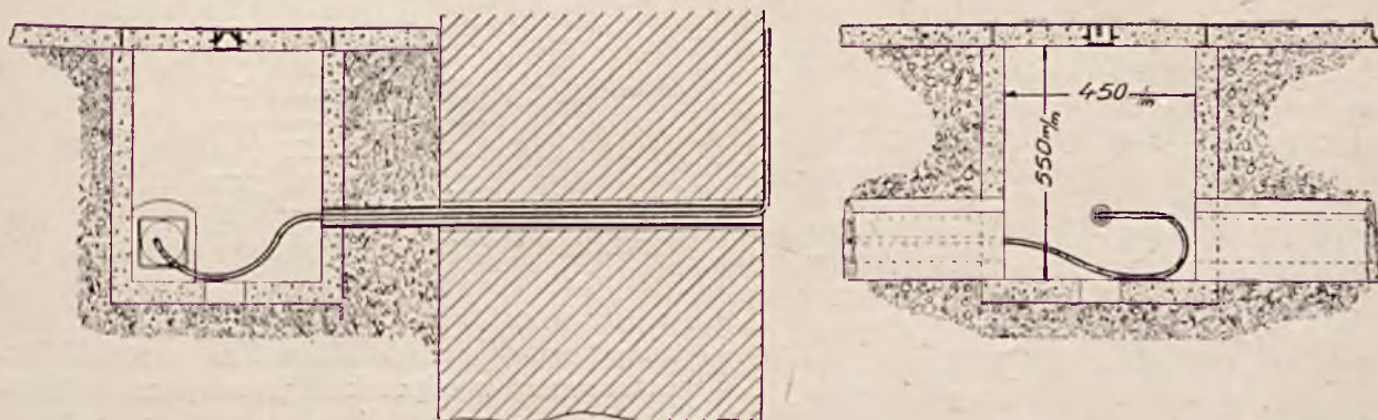
RYŚ. 7. STUDZIENKA DO KANALIZACJI 1-OTWOROWEJ.
