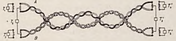
RYS. 8. SKRĘCENIE PAR I CZWÓREK PRZEWODÓW KABLOWYCH.
