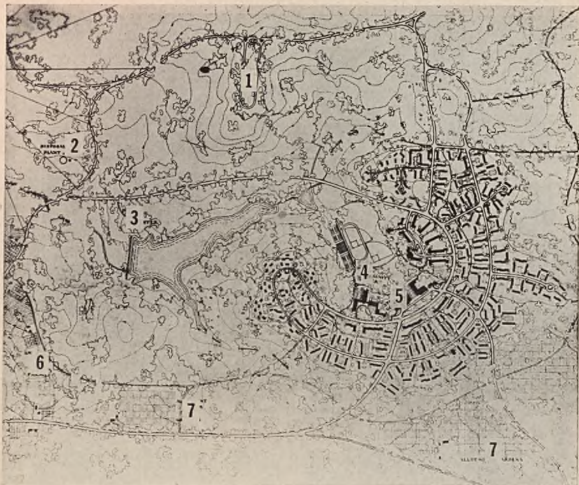
Rys. 520. Plan zabudowania osiedla Greenbelt pod Waszyngtonem, budowanego przez Urząd Rozmieszczenia Ludności St. Zjedn. Proj. arch. H. Walker. 1 — Wieża ciśnięż. 2 — Spalarnia śmieci. 3 — Park. 4 — Ośrodek administracyjny. 5 — Sklepy. 6 — Osiedle ogrodnicze. 7 — Ogródki działkowe.
