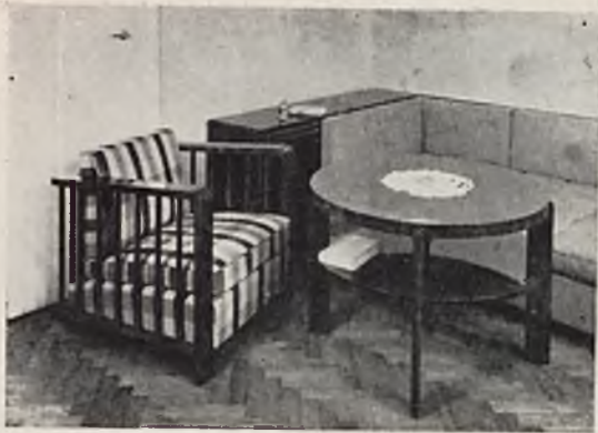
Rys. 296. Nieracjonalne stosowanie fornierowania do kształtów zaokrąglonych
