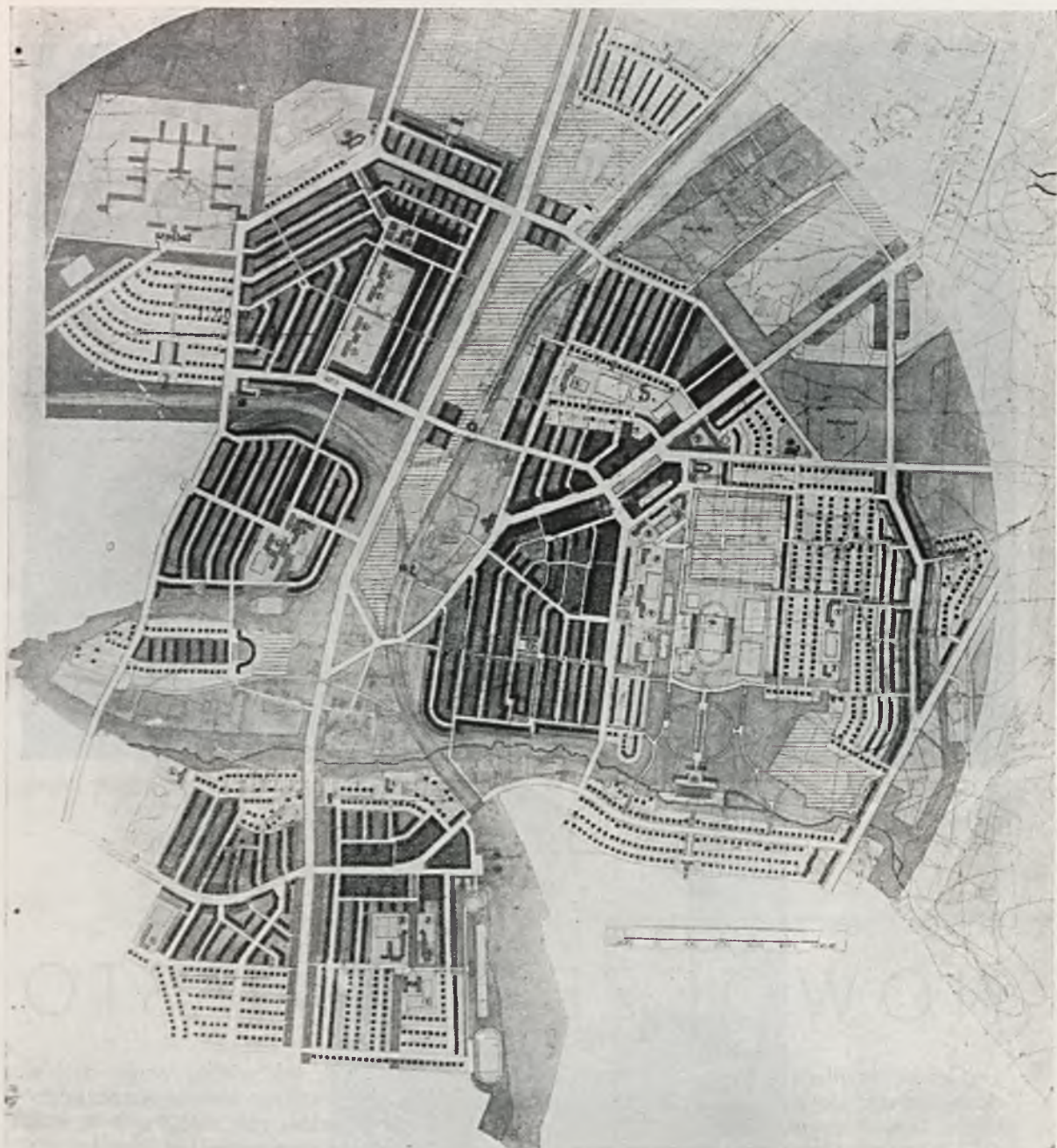
Rys 396. Arch. W. Czarnecki i M. Spychalski: Projekt konkursowy planu zabudowy m. Katowic. Dzielnice mieszkalne połączone gronowo z arterią komunikacyjną. Ośrodki użyteczności publicznej umiejscowione w każdej dzielnicy.
