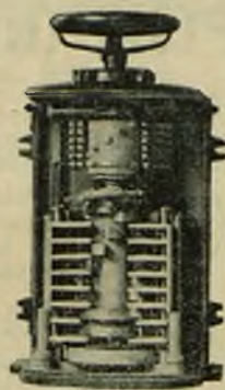
Nastawnik prądu stałego z regulacją obrotów
