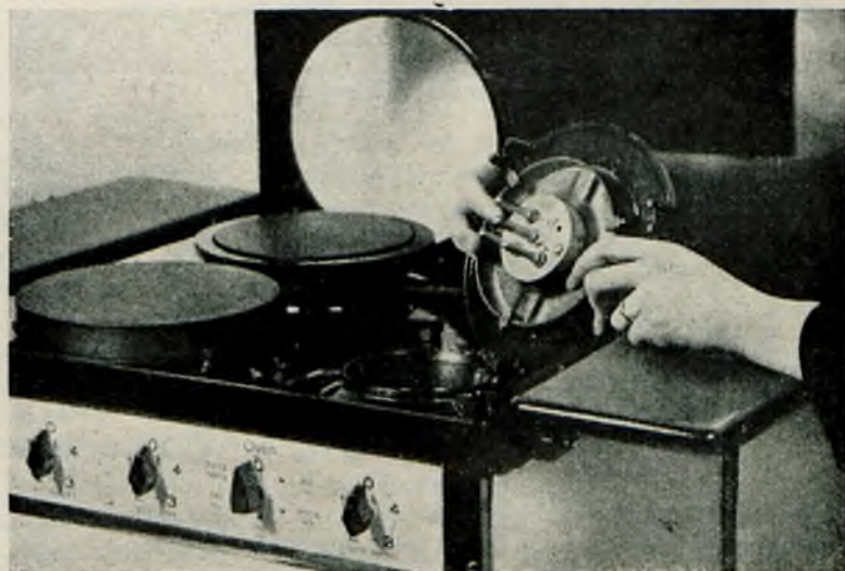
Rys. 15. Wyjmowanie płytki z kuchni.
