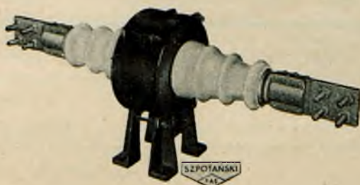
Rys. 2. Transformator prądowy mod. JL20 o przekładni 1 000/5 A dla napięcia roboczego 20 000 V. Nap. próbne 64 000 V.
