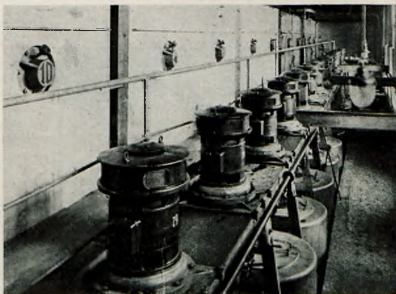
Rys. 14. Grupa silników, napędzających wirówki w cukrowni Środa.
