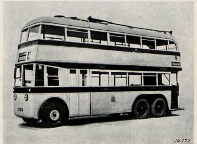
Rys. 4. Wóz w Newcastle. 65 miejsc siedzących (Karrier Motors Ltd).
