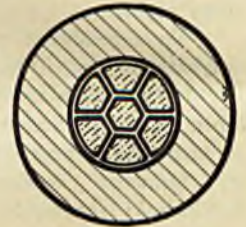
Rys. 3. Szcik jednego przewodu cewki generatora f. BBC
