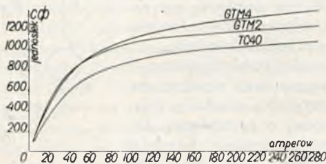
Rys. 3. Krzywe strumieni silników TC40, GTM2 i GTM4.
