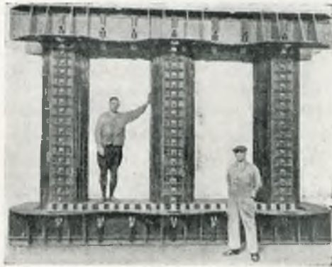
Rys. 3. Rdzeń transformatora o mocy 45 000 kVA (Asea).
