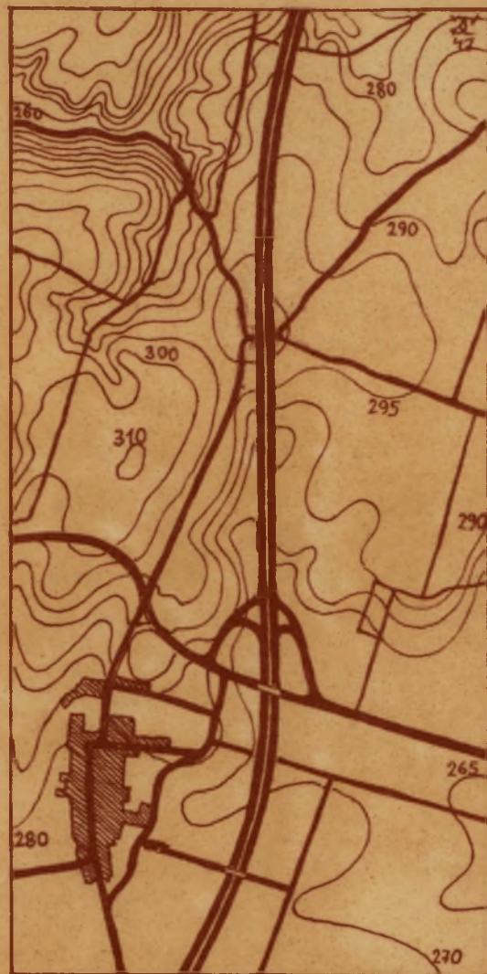
Rys. 3. Nowoczesna autostrada o płynnym przebiegu trasy, posiadająca dwupoziomowe skrzyżowania, zapewnia bezpieczeństwo ruchu przy dużej szybkości. /wg. mapy 1:25.000 - okolice Wrocławia/
