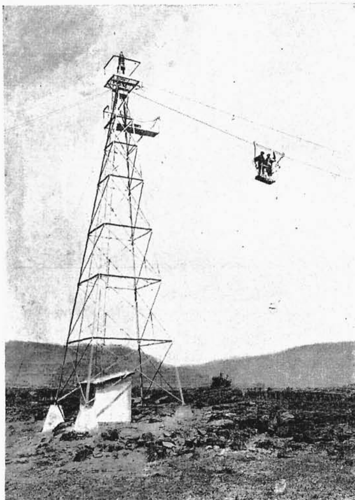
Rys. 298. Pomiar młynkiem z wózka kolejki linowej.
