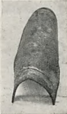
Rys. 3. Próba na zginanie. Warstwa zewnętrzna jest z ołowiu.
