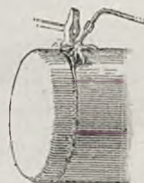
Rys. 3. Usuwanie fałdy, utworzonej na skutek nieumiejętnego spawania.
