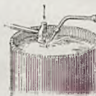
Rys. 2. Prostowanie dna zbiornika.
