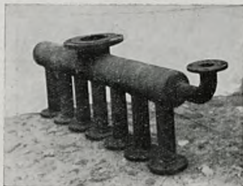
Rys. 6. Skraplacz po spawaniu.
