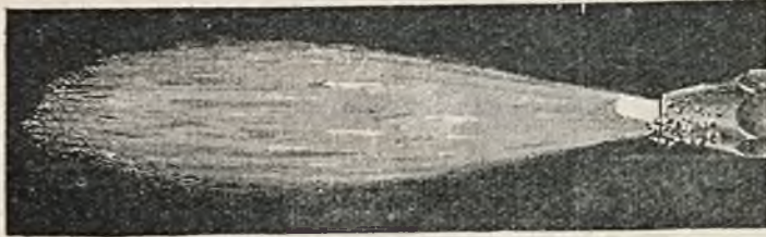
Rys. 122. Odchylenie płomienia przez przylegające do wylotu tlenki.
