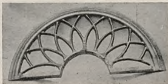
Rys. 16 i 17. Osłona żeliwna przed spawaniem i po spawaniu.
