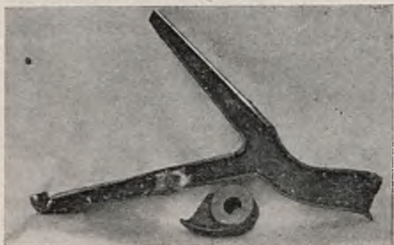
Rys. 14 i 15. [Podstawa szpuli złamana i naprawiona.
