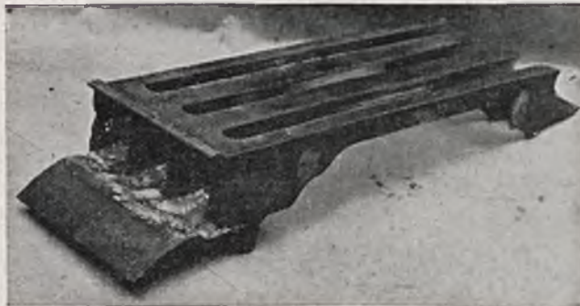
Rys. 3. Naprawiona skrzynka czółenka.
