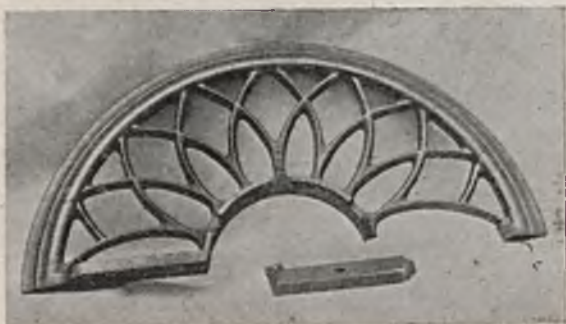
Rys. 16 i 17. Osłona żeliwna przed spawaniem i po spawaniu.
