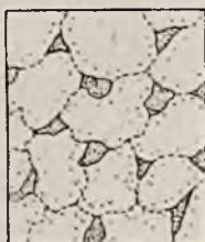
Rys. 10 b. Początkowe kształtowanie się kryształków \gamma przy 700° C.
