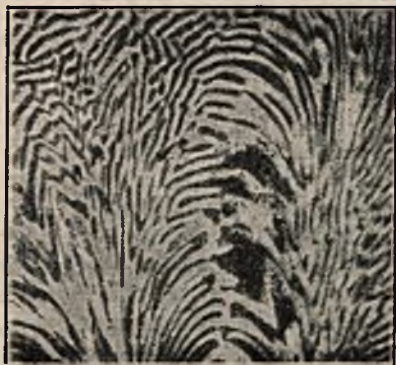
Rys. 3. Fosforan miedzi na przecie miedzianym.
