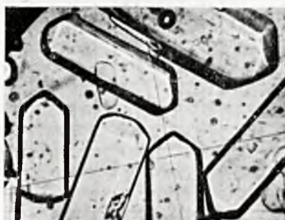
Rycina 13. Siarczan magnezu MgSO_4 \cdot 7H_2O . Przesycenie \Delta C = 4,0 . Stosunek osi y/x = 3,0 .
