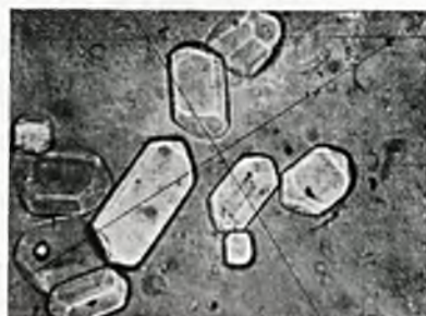
Rycina 12. Siarczan magnezu MgSO_4 \cdot 7H_2O . Przesycenie \Delta C = 3,0 . Stosunek osi y/x = 2,0 .
