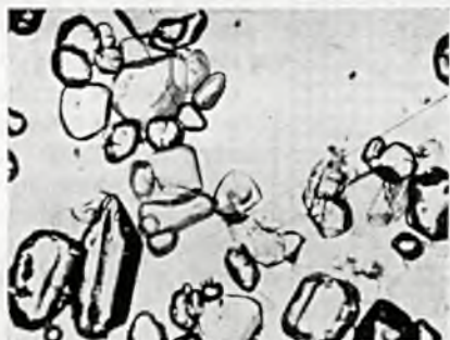
Rycina 16. Azotan potasowy Przesycenie \Delta C = 3,6 . Stosunek osi y/x = 1,7 .
