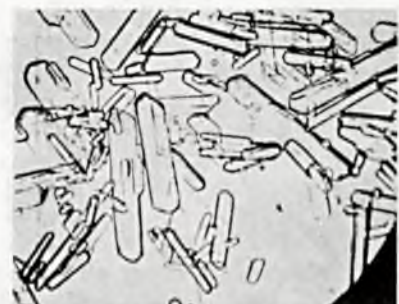
Rycina 14. Siarczan magnezu MgSO_4 \cdot 7H_2O . Przesycenie \Delta C = 8 . Stosunek osi y/x = 9,0 .
