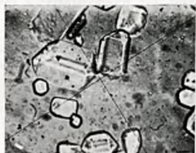
Rycina 11. Siarczan magnezu MgSO_4 \cdot 7H_2O . Przesycenie \Delta C = 1,5 . Stosunek osi y/x = 1,3 .
