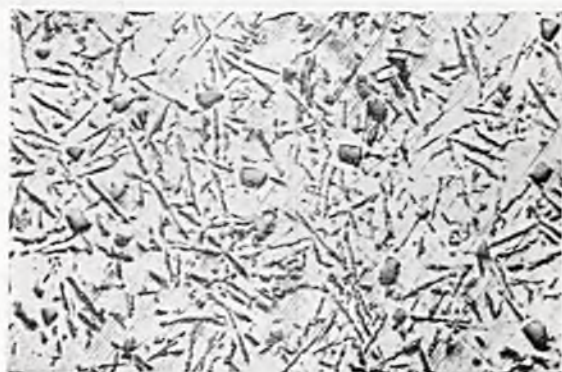
Rycina 1. Mikrofotografia próbki siluminu normalnego, ( \times 150 ), nie trawiona.
