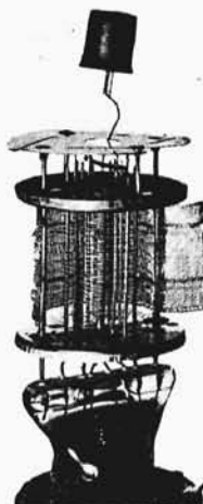
1. Zespół elektrod duodiody-triody ABC 1 (Philips). (Skala 2:3).
