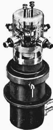
4. Pentoda nadawcza dla fal ultrakrótkich (PA 12/15 Philips). (Skala 1 : 6).
