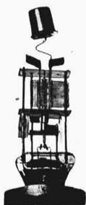
1. Zespół elektrod duodiody-triody ABC 1 (Philips). (Skala 2:3).
