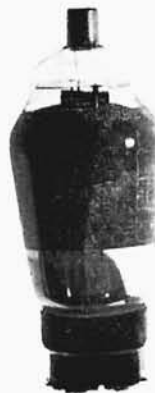
3. Pentoda CL 4 (Philips). (Skala 1 : 2).
