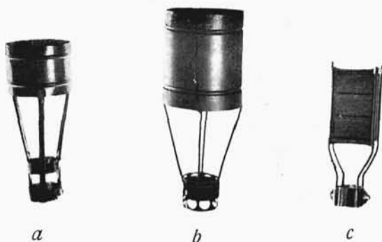
1. Anody lamp nadawczych średniej mocy. (Skala 1 : 4).
