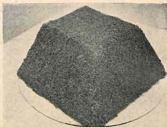
Rys. 25. Zanieczyszczenie piasku w filtrze Nr. 2 po 267 dniach działania (warstwa trzecia).
