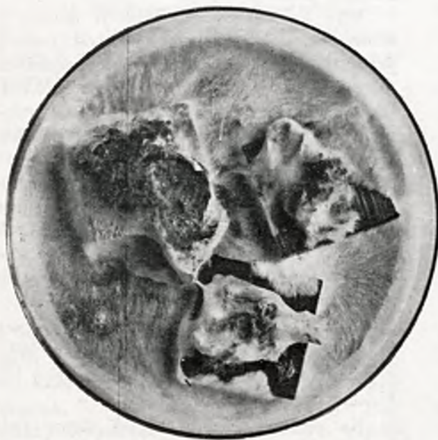
Rycina 2: Typowy obraz niedostatecznego zabezpieczenia grzyb atakuje drzewo zaimpregnowane. Image typique de l'impregnation insuffisante, le champignon attaque le bois.
