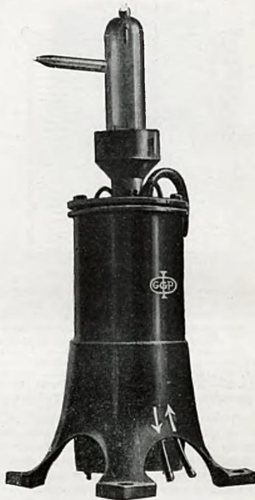
Rysunek 7. Pompa ze skraplaniem typu C Langmuir'a o parze rtęciowej Zakładów Gaiffe-Gallot & Pilon. (Widok ogólny).
