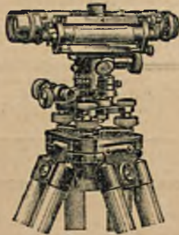
Niwelator I, szczególnie nadaje się do celów technicznych.
