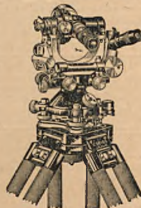
Teodolit I najnowszej konstrukcji. Wysokość: 200 mm.
