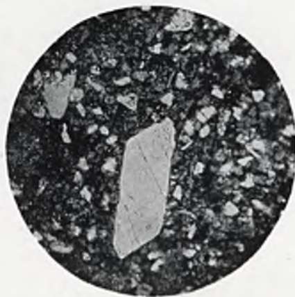
Fig. 8. Spoiwo fosforytowe z Niezwisk, światło zwykłe, pow. około 30-krotne, w środku pola widzenia kwarciec autogeniczny.
