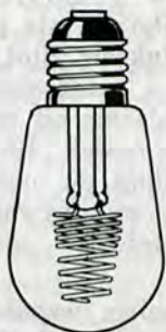
Ryc. 130. Lampka jarząca z poświatą katodową.
