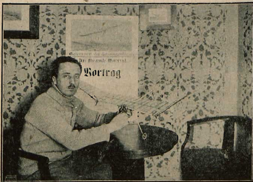
Karol Cerny, wynalazca latającego motocykla. Aeromotocykl, jak widać na ilustracji, jest kombinacją, wzorowaną na zwykłym jednopłacie w połączeniu z orlikopterem czyli skrzydłowcem.
