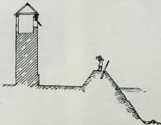
Rys. 39. Przekrój muru obronnego w Salzburgu, podług Essenweina.
