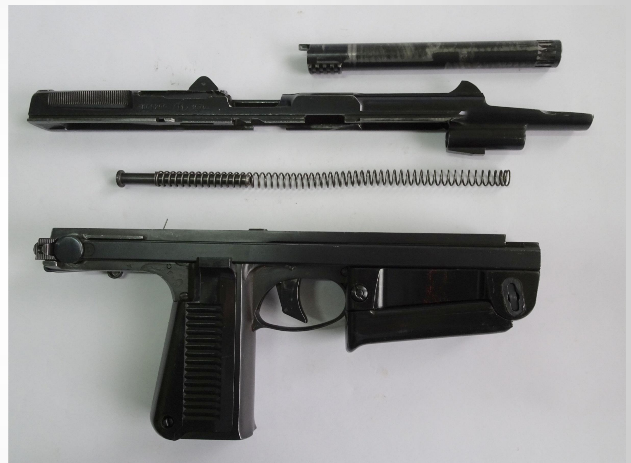
Pistolet wz. 1963 częściowo rozłożony Zdjęcie J. Kostro
